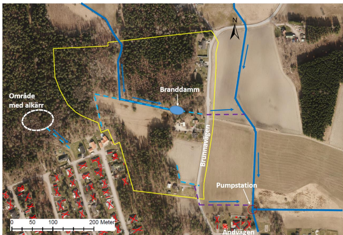
Figur 2. Planområde (gul linje), diken som ingår i markavvattningsföretag (blå heldragna linjer), övriga öppna diken (blå streckade linjer), ungefärligt läge på kulvertar (lila linjer) samt läge för pumpstation.
