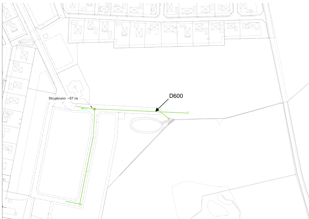
Figur 5. Bef. dagvattenledningar i Åkerivägen och strypbrunnen nedströms dammen.
