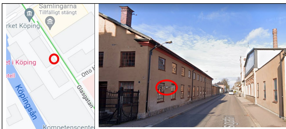
Fig. 2: Mätstationens placering på Glasgatan på kartan (vänster) samt gaturummets utseende i riktning mot NNW. Vägbanan är ca 5 m bred och gaturummet (avstånd mellan byggnader) 8 m. Byggnaden till vänster är ca 10 m hög, byggnaderna till höger mellan 6 och 12 m höga.
