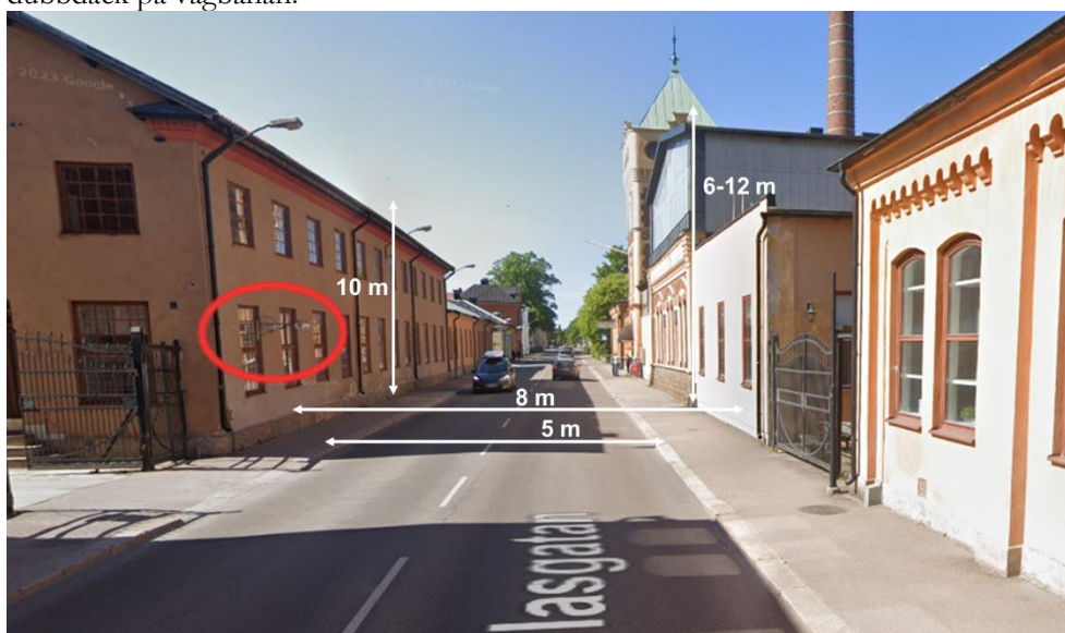
Bild 1. Bilden från Google maps visar en gatuvy över Glasgatan. Mätstationen är inringad på vänster sida. Angivna mått används vid gaturumsmodellering.
