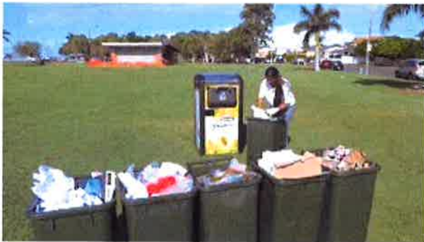
I en enda smart tunna med en komprimator får det plats sex gånger så mycket sopor.
