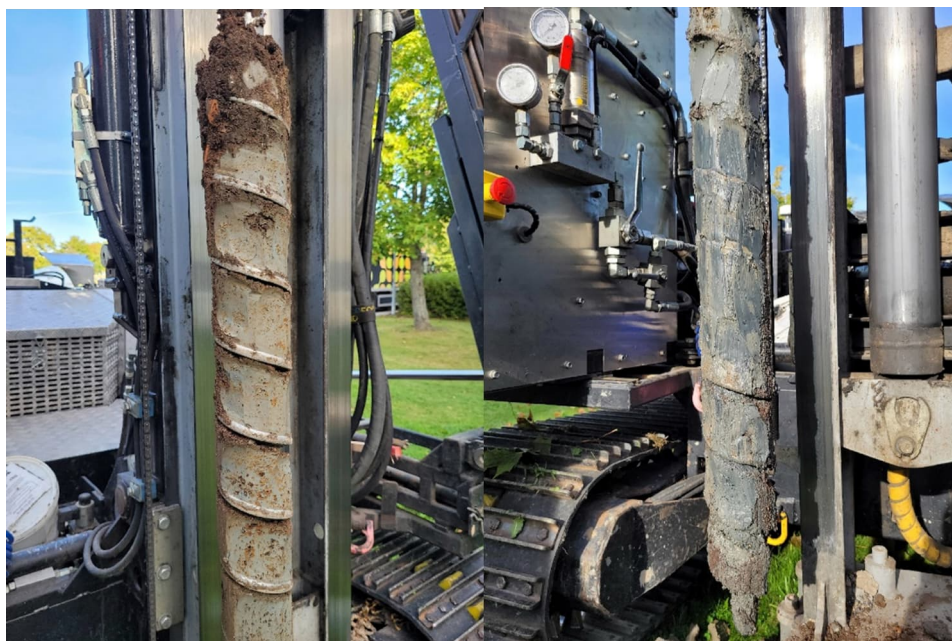
Figur 7. Fotot till vänster visar upptaget jordprov från provpunkt 24TY08J nivå 1,0-1,5 meter. Fotot till höger visar upptaget prov från samma provpunkt nivå 2,5-3,0 meter.
