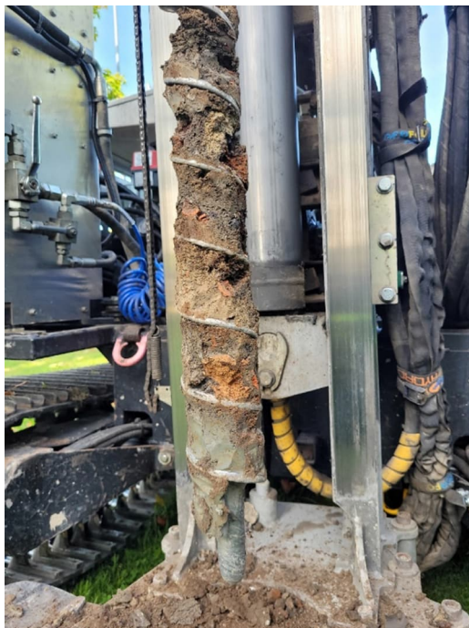
Figur 6. Fotot visar upptagen skruv med jord från provpunkt 24TY08J nivå 0,0-0,5 meter under markytan.
