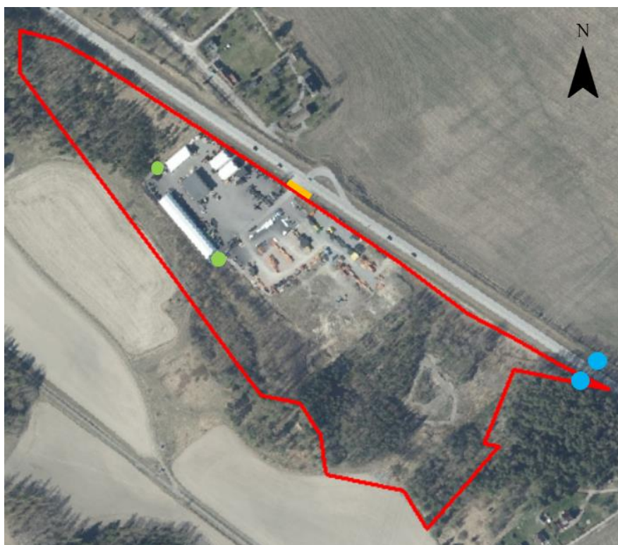
Figur 4. Gröna markeringar visar ut eller inlopp på befintliga ledningar i området. Blå markeringar visar kupolbrunnar och orange markering visar vägtrumma under infartsväg.
