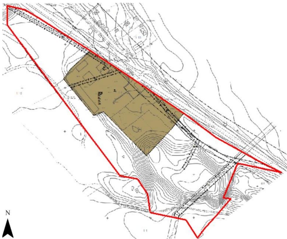
Figur 2. Utkast till plankarta. Röd markering visar plangräns och brun markering visar område som tillåts exploateras. (WSP, 2020)
